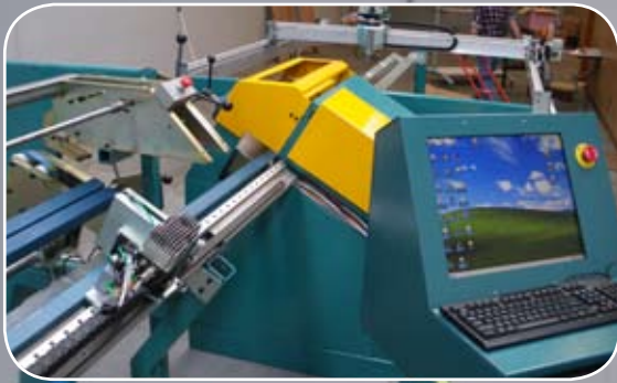
Motorised Mitre Angle ( \pm 60^\circ )
